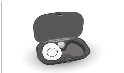
Obrázek 2: Ochranné pouzdro s audio procesorem Samba a jeho baterií (s kladným pólem (+) směrem dolů)
